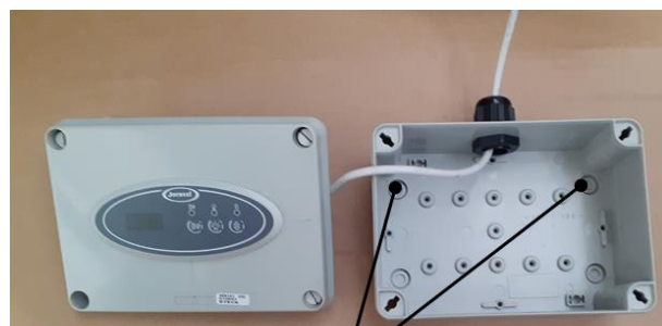
Locais para furos na caixa do módulo
